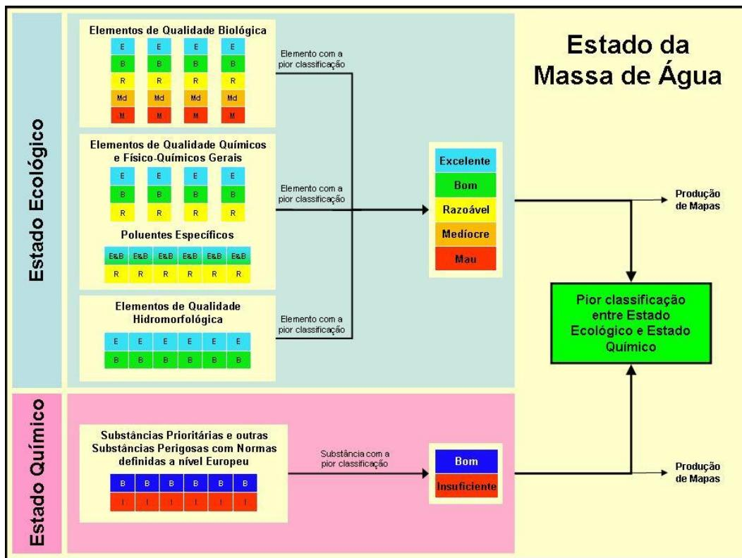
**Figura 5.1 - Esquema conceptual do sistema de classificação do estado das águas superficiais (adaptado de UK TAG, 2007)**
