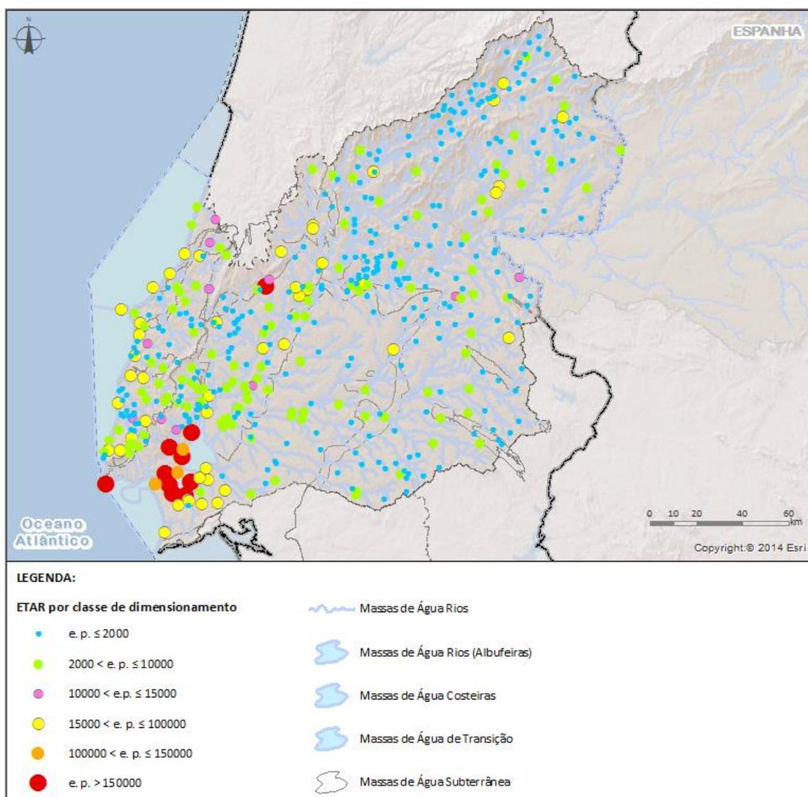
Figura 3.4 - ETAR por classe de dimensionamento na RH5
