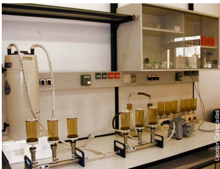
Figura 8 - Rampa de filtração.
