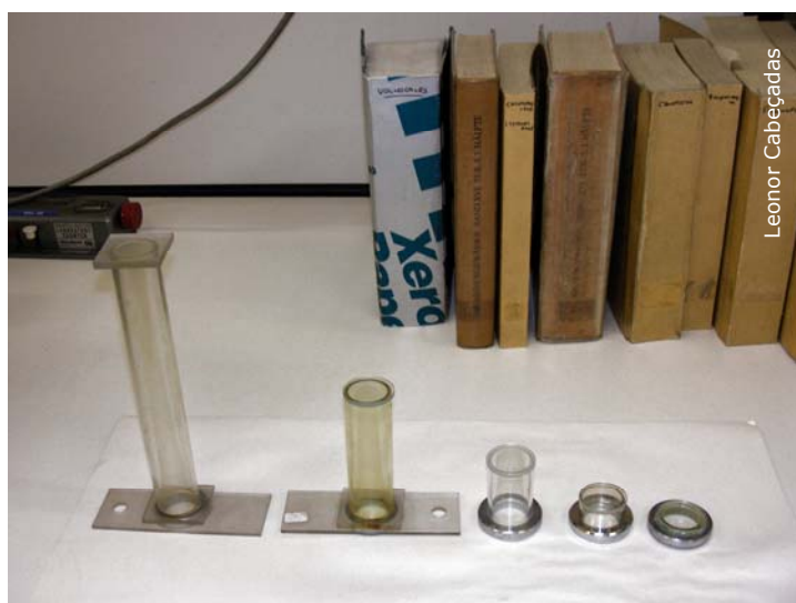
Figura 11 - Câmaras de sedimentação. Duas câmaras compostas (esquerda) e três câmaras simples (direita).
