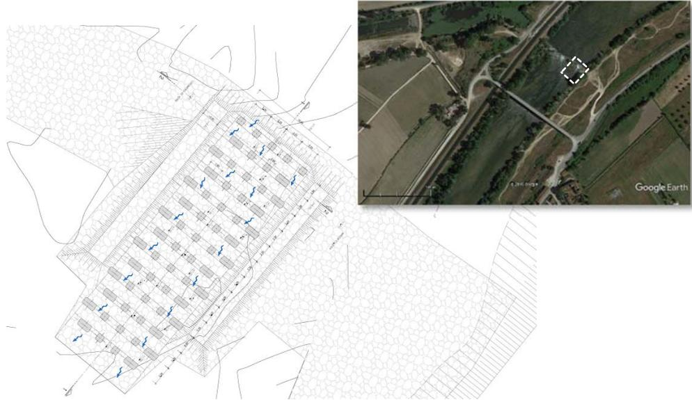
**Figura 5. Rampa para peixes do Açude da Formoselha, vista em planta. Vista aérea com o local da intervenção assinalado.**
