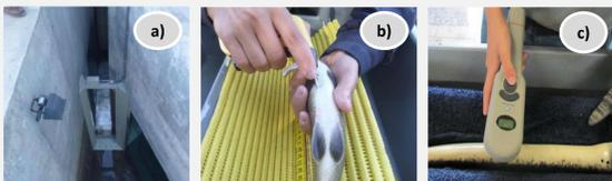
Fig. 1 - a) Antena de deteção do sistema PIT; b) procedimento de marcação e c) leitura e registo do código da marca PIT.
