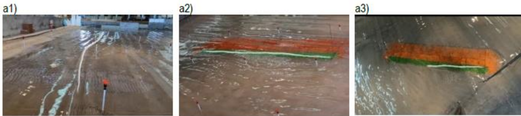
Figura 6.1 – Ensaios físicos: variação da superfície livre e posição da linha de rebentação. a1) sem QMD; a2) QMD 0°; a3) QMD 45°. Agitação regular: T=12 s; H_s=2,0 m, NMM
