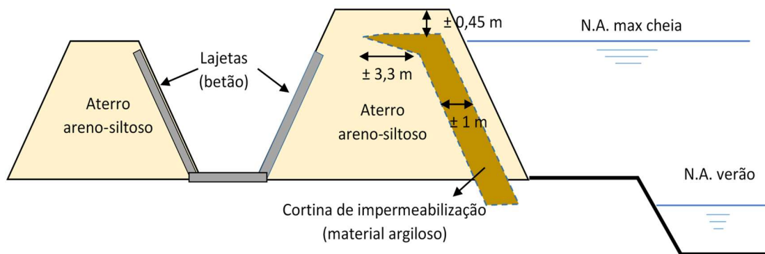
Figura 4.14 – Corte esquemático do dique na margem direita na zona onde ocorreu a rotura, sob a A1 (valores medidos in situ).
