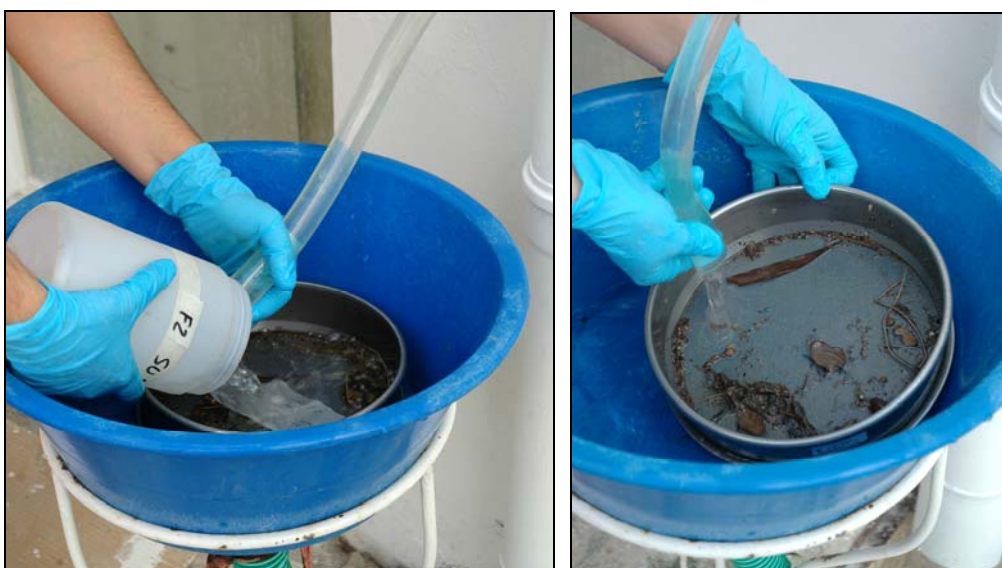
Figura 13. Lavagem do material colhido através de crivos de malha calibrada
