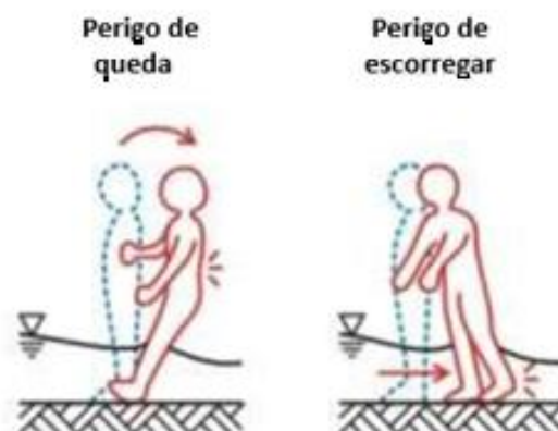
Figura 53 - Instabilidade causada em pessoas em situação de inundação (adaptado de Shand et Al., 2011)
