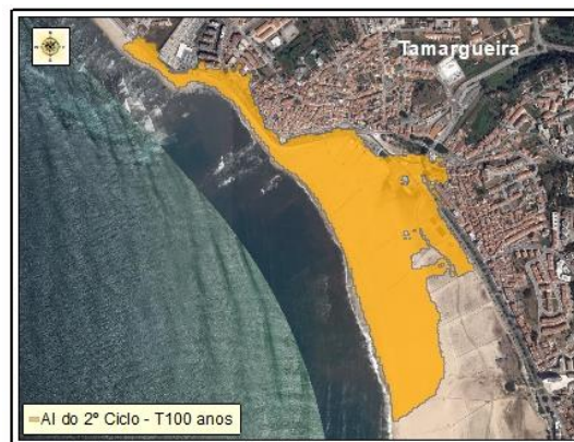
Figura 34. Área inundável da ARPSI da Tamarqueira, para período de retorno de T=100 anos
