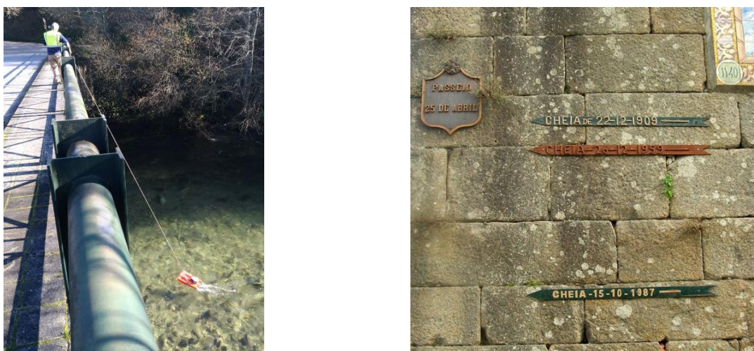
Figura 6. Elementos necessários à modelação hidrológica e hidráulica, medição de caudal e marcas de cheia
