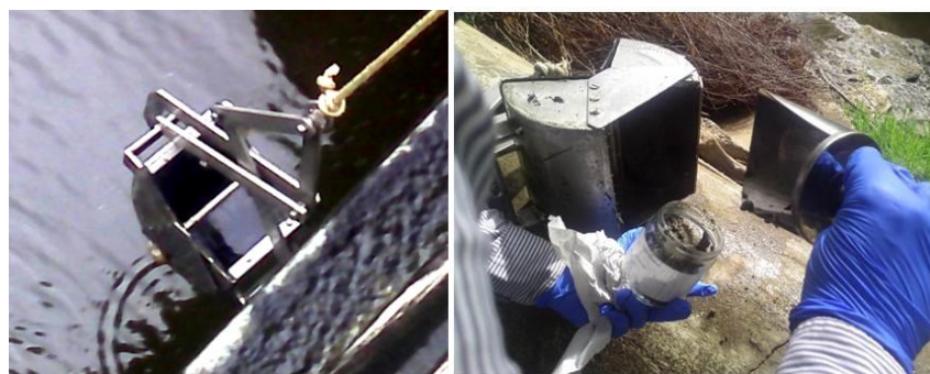
Figura 3.7 – Draga tipo “Petit Ponar”.
