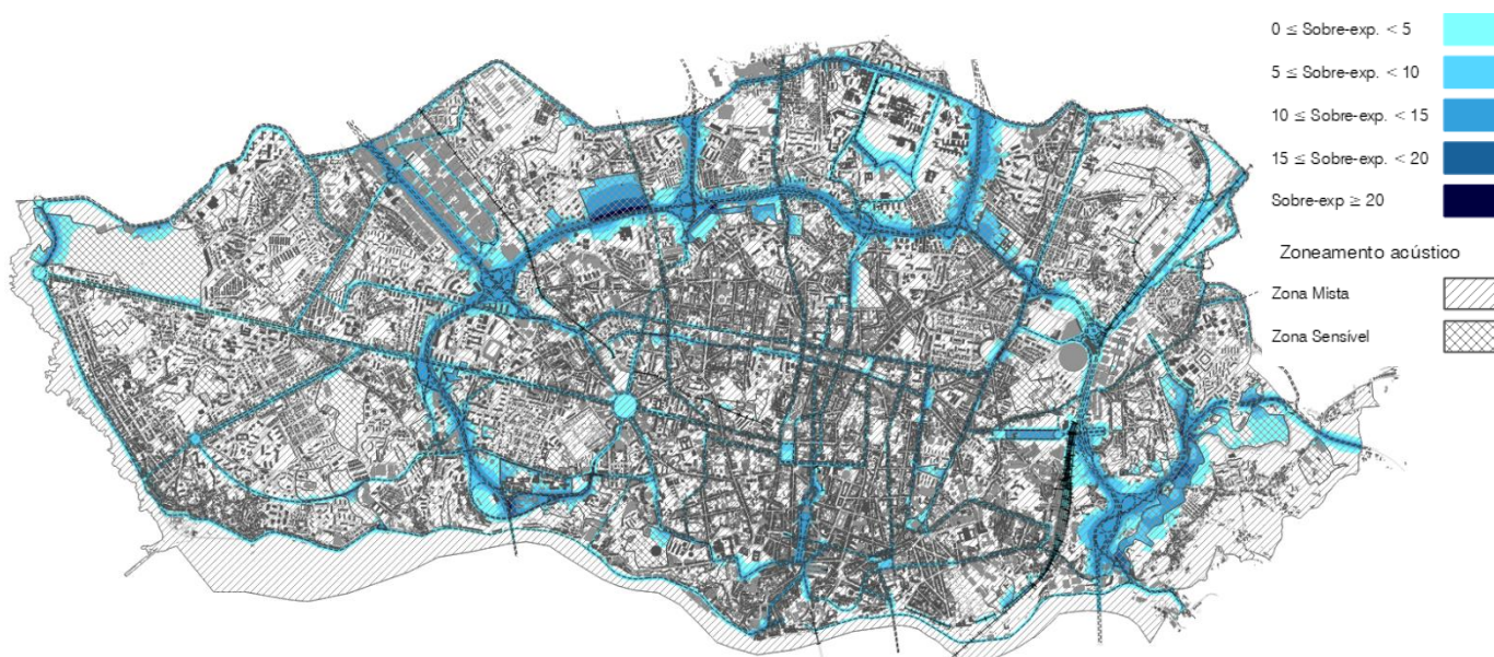
Figura 20 – Representação gráfica do Mapa de Ruído Global de Sobre-exposição ao Ruído, indicador diurno-entardecer-noturno L_{den}
