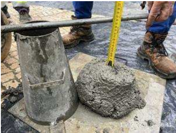
Frente de obra da plataforma Superior do Ascensor – Ensaio de Slump - 15/02/2024 - GR P518/0085416
