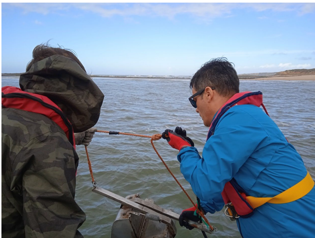
Foto 3.1 - Amostragem de macroinvertebrados com recurso a uma draga do tipo Van Veen.
