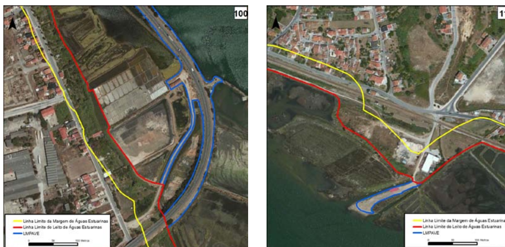
Figura 28: Demarcação da LMPAVE, linha limite do leito e da margem em zona de aterro no leito dominial Acessos à ponte Edgar Cardoso em aterro e aterro em Vila Verde – Estuário Mondego, Figueira da Foz
