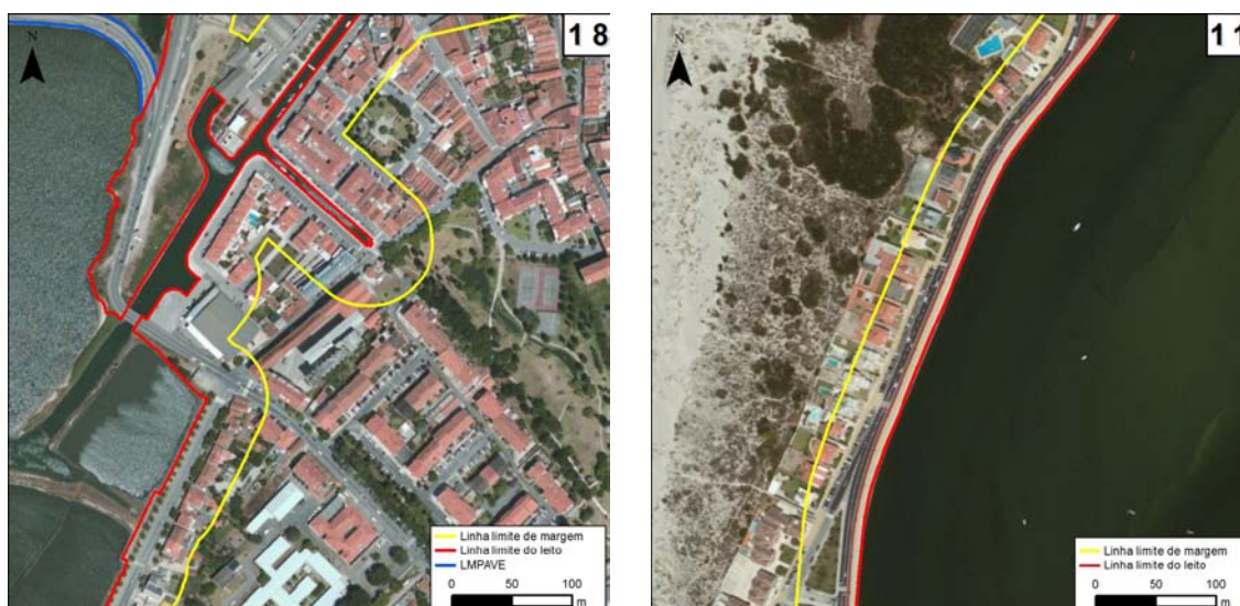
Figura 14: Representação da demarcação da linha limite do leito em taludes artificializados Canais urbanos da Cidade de Aveiro e Costa nova em Ílhavo
