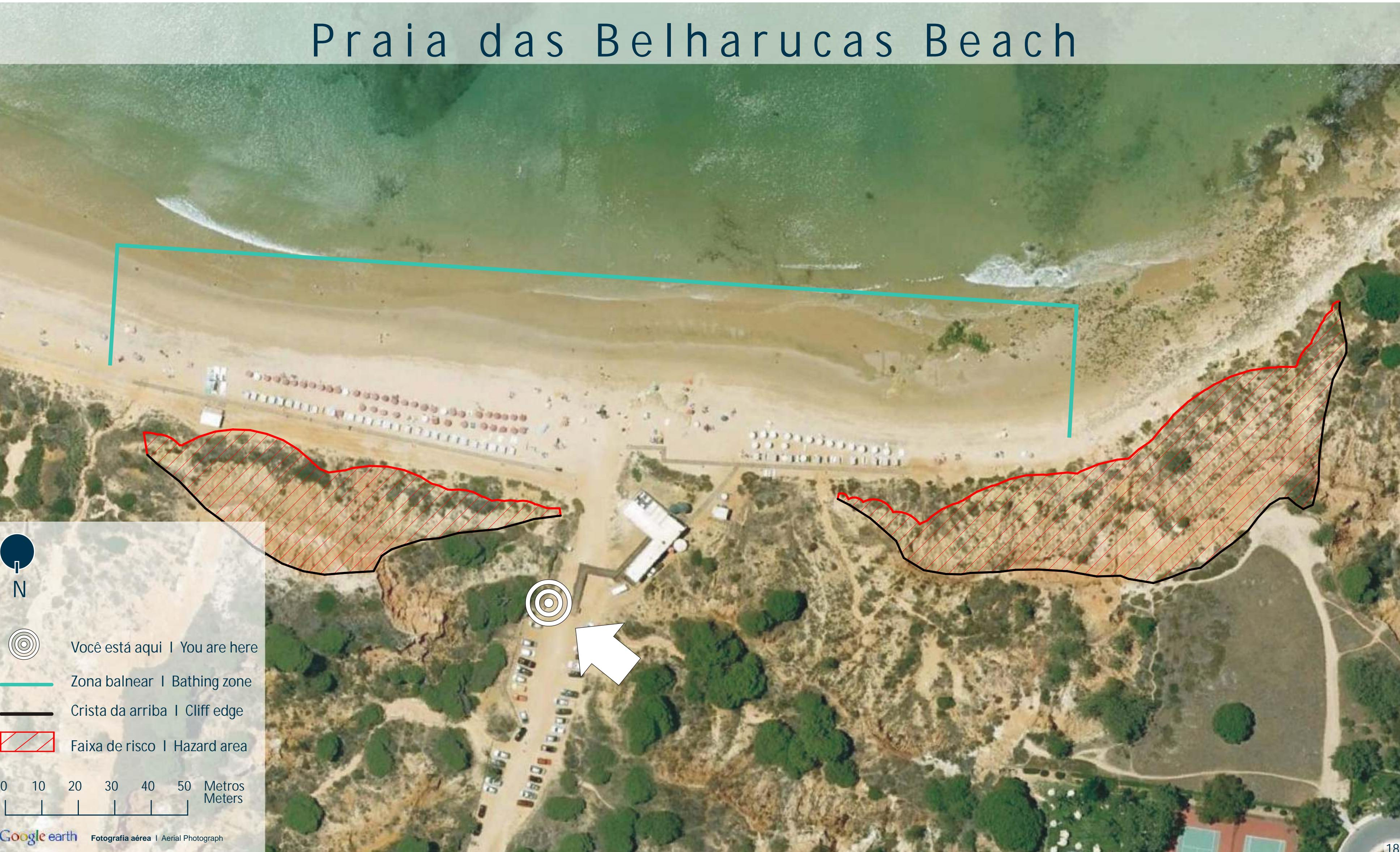
A evolução (erosão) natural das arribas processa-se numa sequência intermitente e descontínua de derrocadas instantâneas, dinâmica que constitui perigo para os utentes das praias. A FAIXA DE RISCO corresponde à área passível de ser ocupada pelos resíduos de desmoronamentos e tem largura igual a 1 vez a altura da arriba. Para sua segurança permaneça afastado do topo e da base das arribas.
