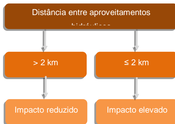
Figura 2.20 – Critérios para avaliar os impactos potenciais nas MA resultantes da presença de infra-estruturas transversais através da distância entre estas.
