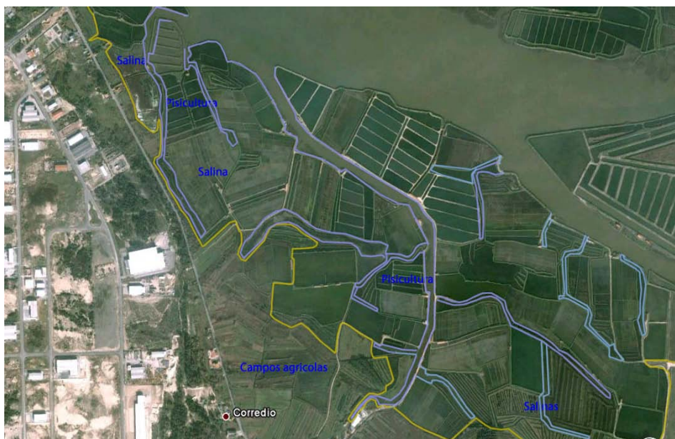
Fig. 3.3.5 Rede de canais que conduzem as águas sob a influencia da maré
