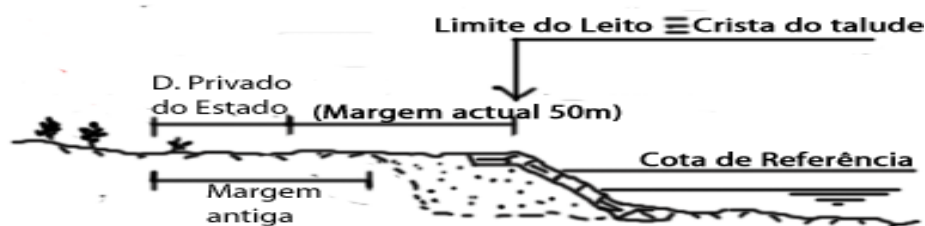
Fig. 3.2.13 Taludes artificializados, em aterro – Limite do leito
