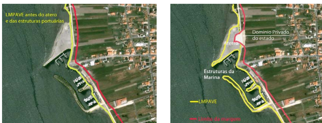
Fig. 3.2.17 Exemplo de demarcação da LMPAVE pelo actual limite do leito - Marina da Gafanha da Encarnação
