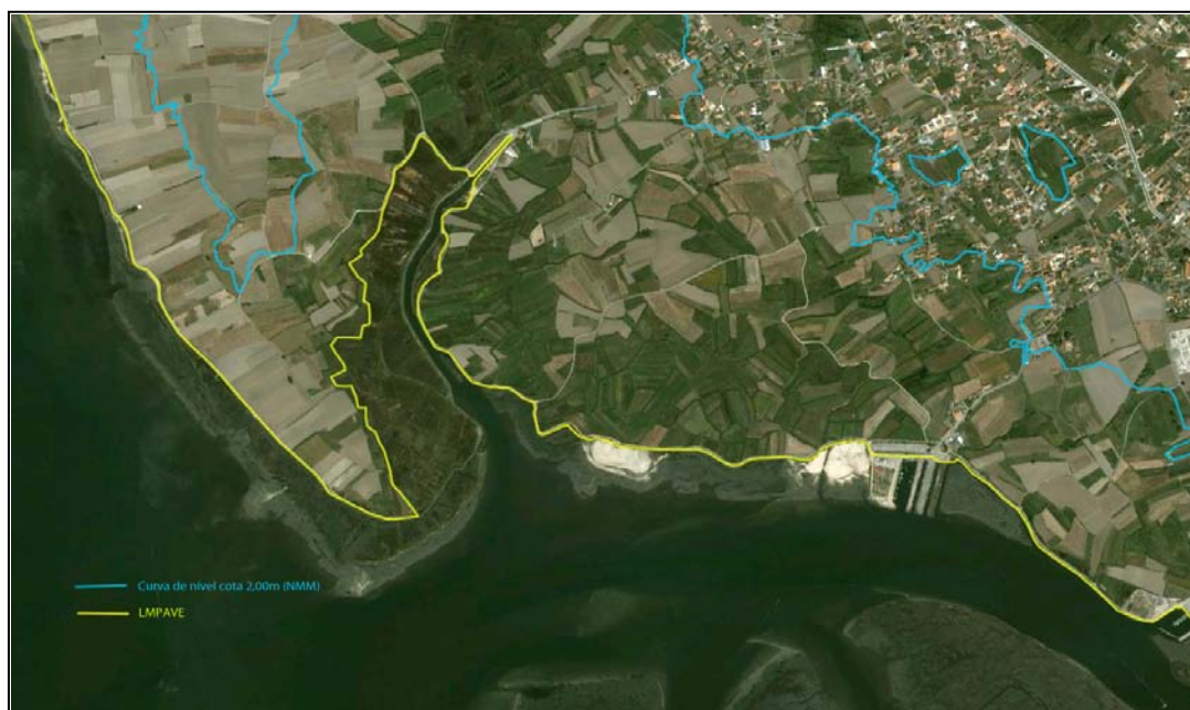
Fig. 3.2.11 Demarcação da LMPAVE pelo limite da vegetação halófitas e linha correspondente à cota 2.00m (Cota extraída de levantamento aéreo fotográfico à escala 1/5000 a pós produção de modelo digital do terreno)
