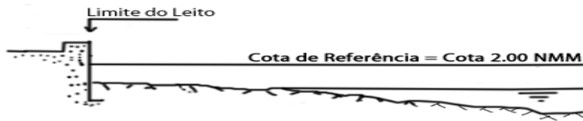
Fig. 3.2.18 – Limite do leito em zona das estruturas portuárias coincidente com o traçado da LMPAVE
