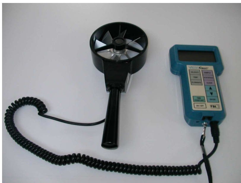
Figura 21 – Sensor de velocidade do ar tipo turbina.
