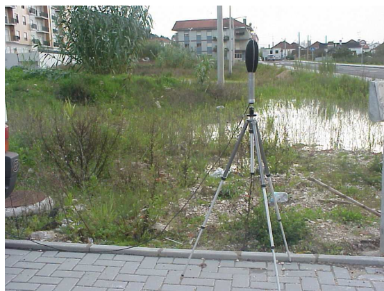
Figura 20 – Kit de exteriores utilizado para monitorização permanente
