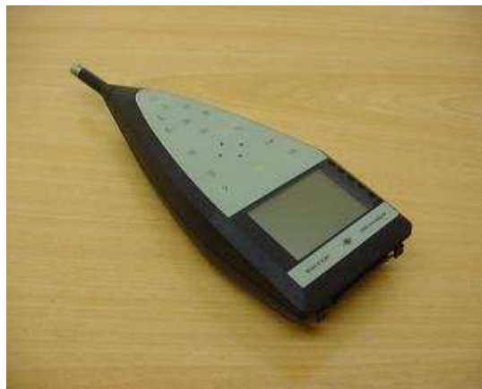
Figura 19 – Sonómetro de precisão integrador
