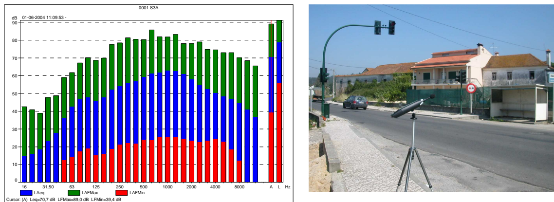
Figura 7 – Exemplo de monitorização do nível de pressão sonora junto a uma via rodoviária
