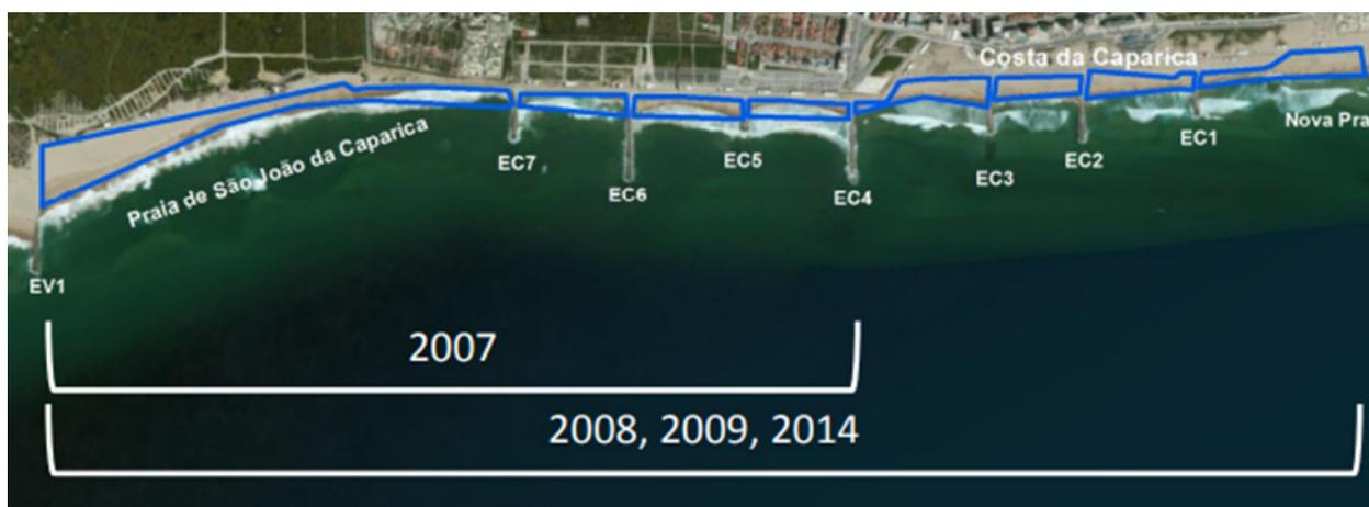
**Fig. 19 – Localização e extensões máximas das intervenções de alimentação artificiais – adaptado por Pais (2021) a partir de Pinto et al. (2018) e APA,I.P. (2019)**
