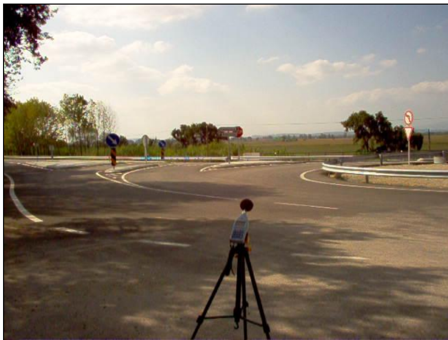
Figura 3.1 – Exemplo de uma medição realizada com o sonómetro numa via rodoviária.
