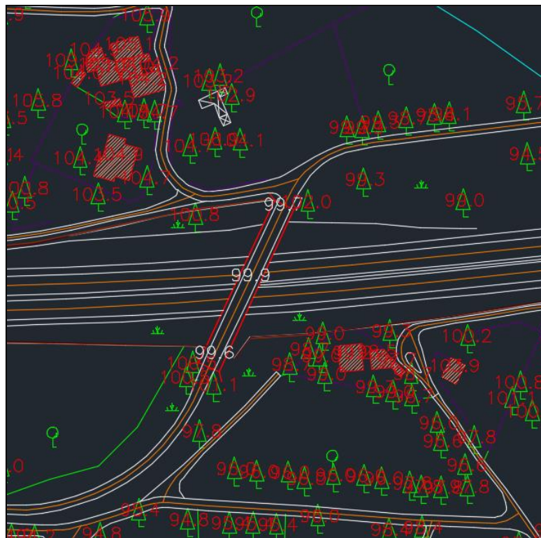
Figura 5-4 – Extrato da planimetria a 1/5 000 elaborada pela Estereofoto , com edifícios, eixos de via, linhas de berma de estradas, muros e vedações, entre outros
