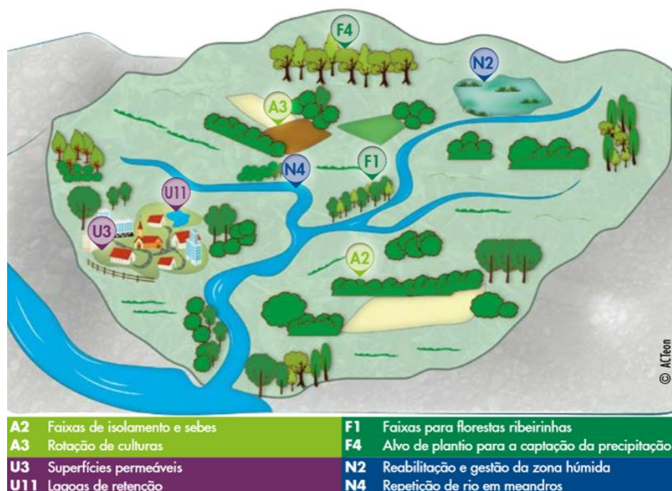
Figura 42 - Representação esquemática de uma bacia hidrográfica e implementação de medidas verdes (adaptado de NWRM, 2013)
