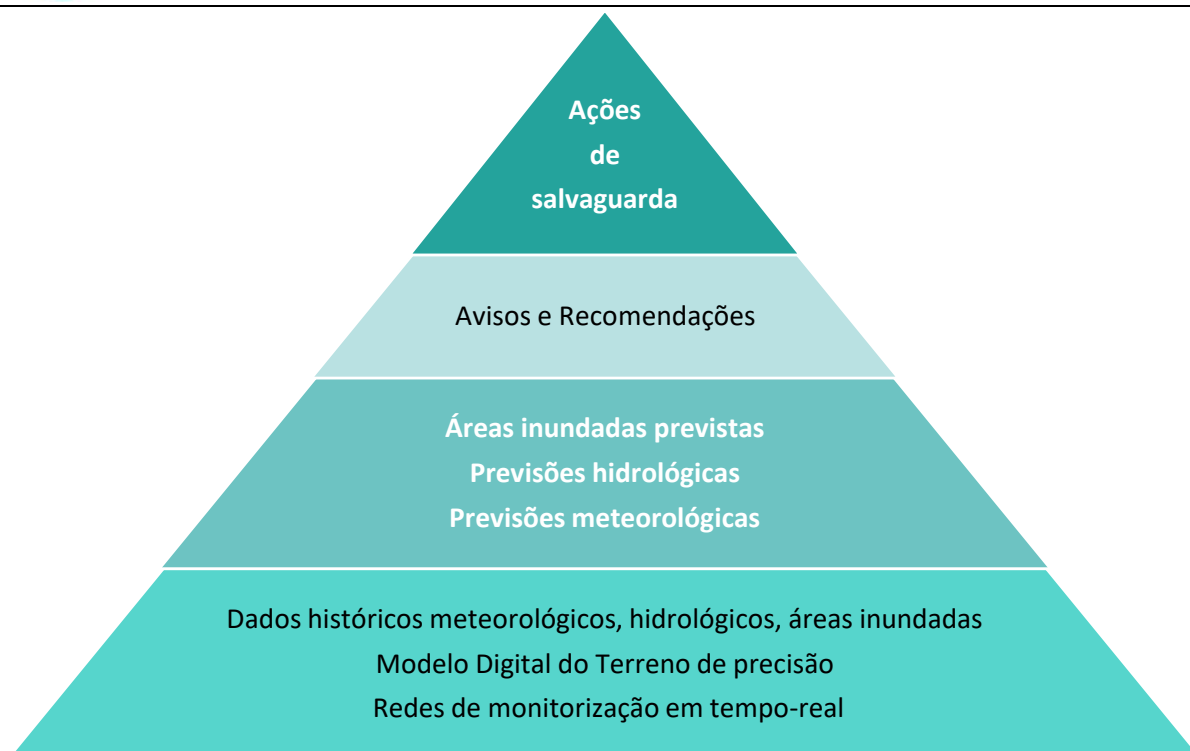
Figura 39 - Componentes de um Sistema de alerta e previsão (adaptado de WMO, 2018)
