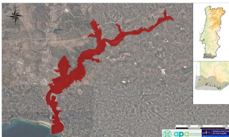
Figura 27 - Área inundada para o período de retorno de 100 anos, ARPSI de Silves (PTRH8Arade01)
