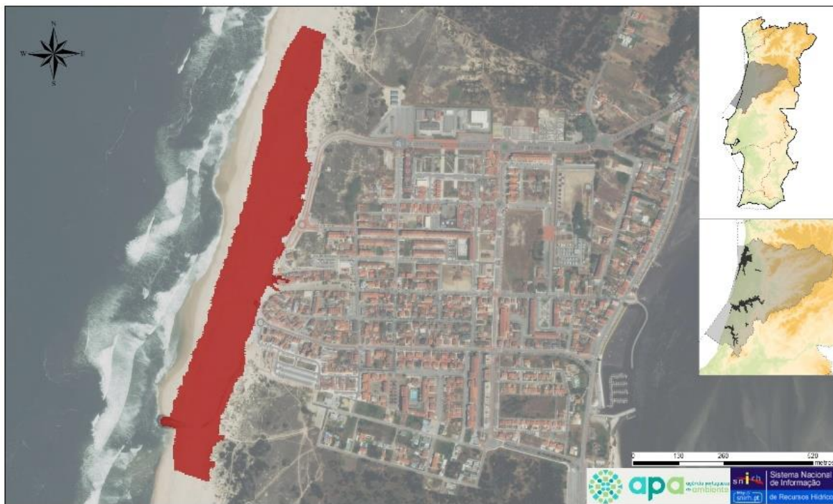
Figura 25 - Área inundada para o período de retorno de 100 anos, ARPSI de Tamargueira (PTRH4ACosteira03)
