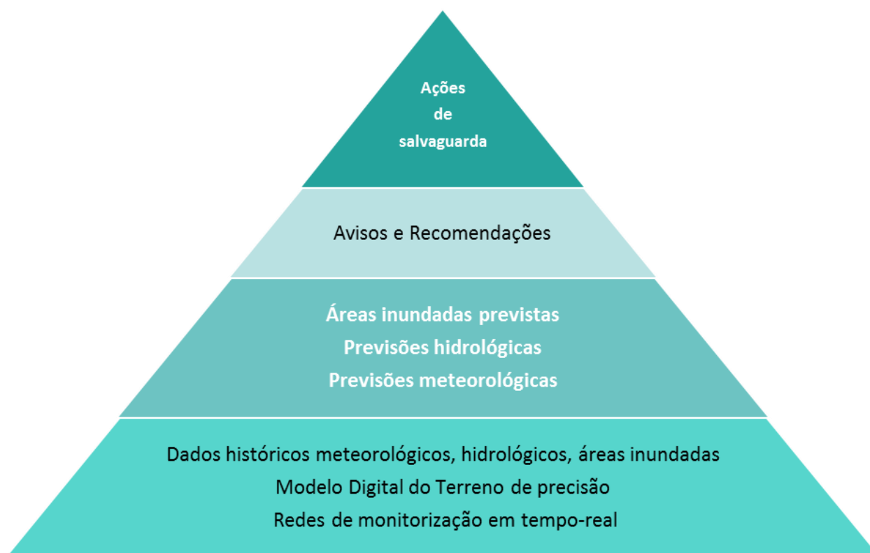
Figura 38 - Componentes de um Sistema de alerta e previsão (WMO, 2018)
