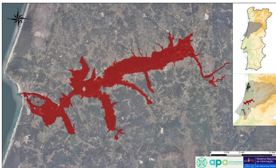
Figura 19 - Área inundada para o período de retorno de 100 anos, ARPSI de Coimbra-Estuário do Mondego (PTRH4AMondego01)
