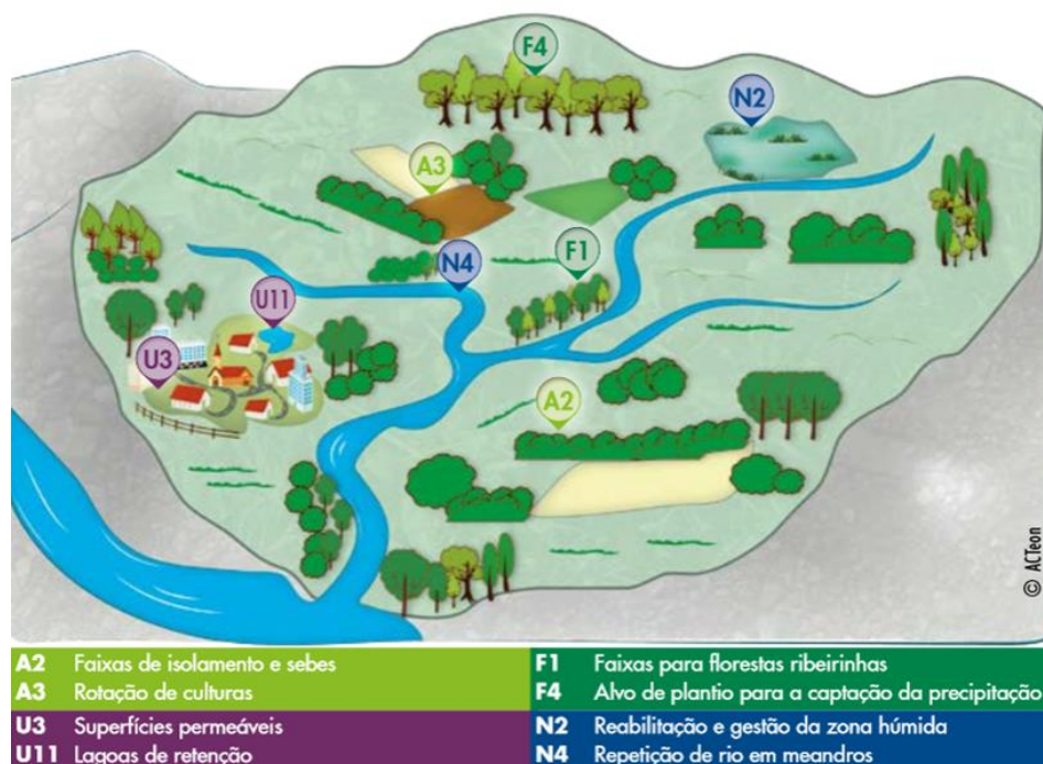
Figura 41 - Representação esquemática de uma bacia hidrográfica e implementação de medidas verdes (NWRM, 2013)
