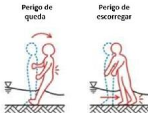
Figura 60 - Instabilidade causada em pessoas em situação de inundação (adaptado de Shand et al., 2011)
