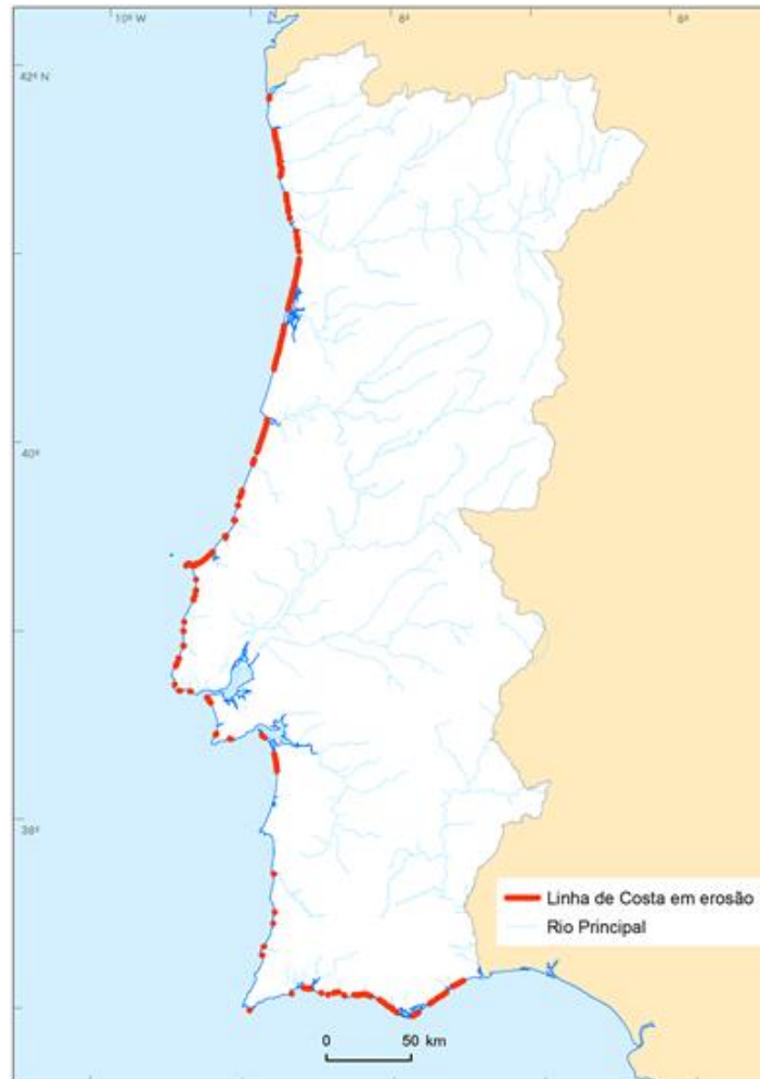
Figura 4.8 – Linha de costa em erosão (evolução de longo prazo)
