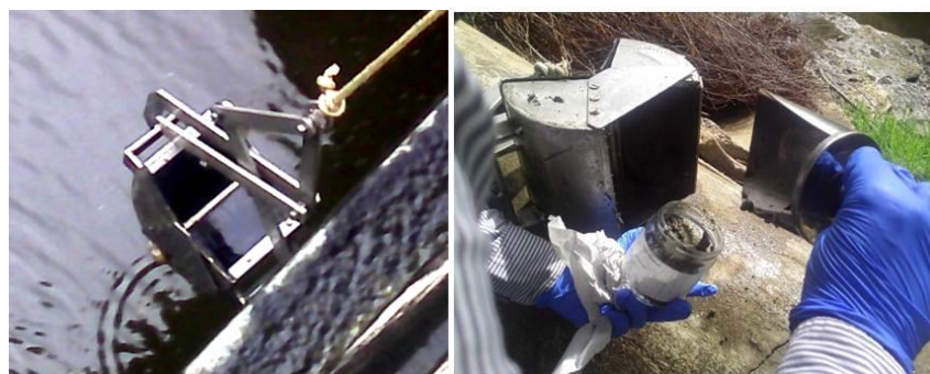
Figura 3.7 – Draga tipo “Petit Ponar”.
