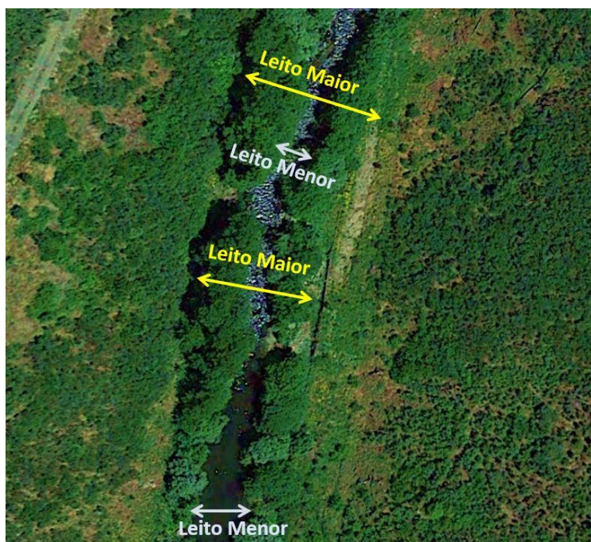
Figura 3.5 - Representação esquemática da delimitação dos leitos menor e maior num curso de água confinado (ribeira da Sertã)
