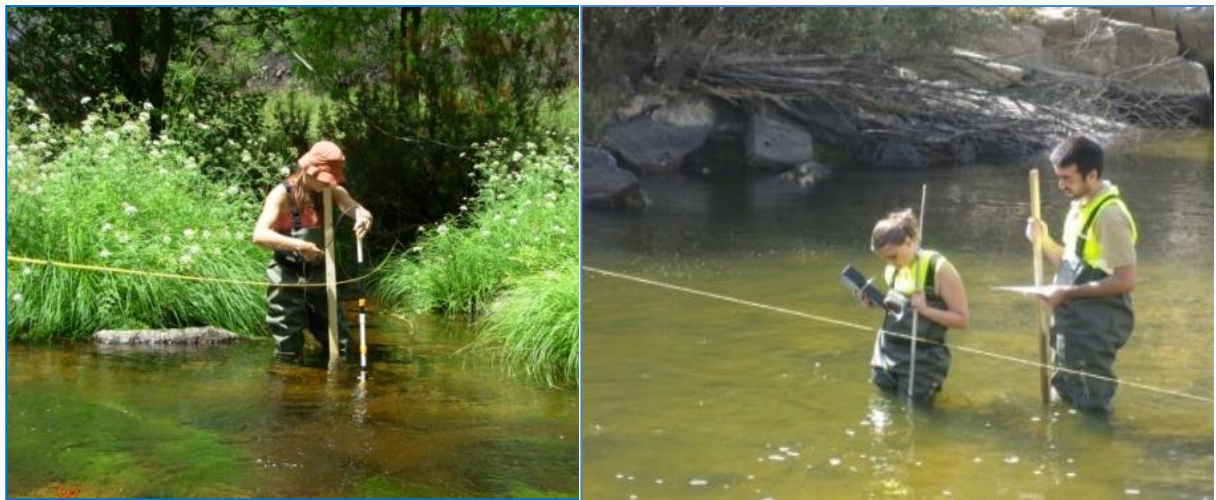
Figura 3.31 - Procedimento de medição de caudal
