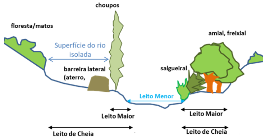
Figura 3.8 - Representação esquemática da limitação da conectividade transversal por estruturas artificiais
