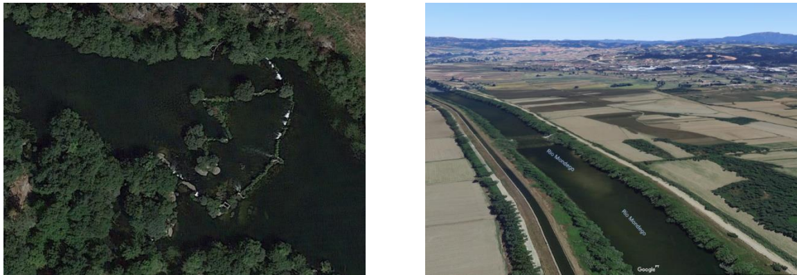
Figura 2.3 - Infraestrutura transversal (pesqueira) identificada remotamente no rio Lima (à esquerda) e margens linearizadas e consolidadas identificadas remotamente no rio Mondego (à direita) (Fonte Google Earth Pro™)
