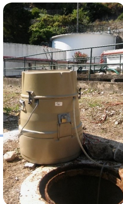
Recolha de amostra composta por recurso a um amostrador automático
