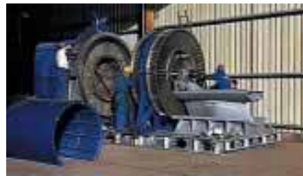
Figura 3.2.7 Turbina Wells da central do Pico na fase de construção
