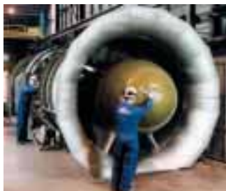
Figura 3.2.8 Turbina da central LIMPET na fase de construção (cortesia Wavegen)
