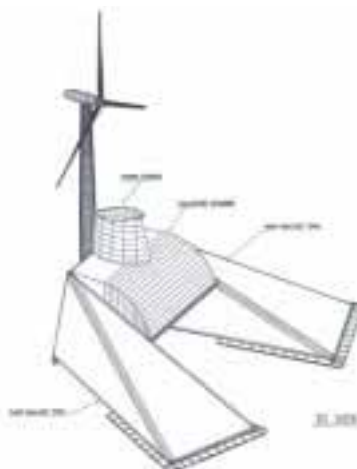
Figura 3.3.2 Modelo do OSPREY com a inclusão do aerogerador para aproveitamento eólico
