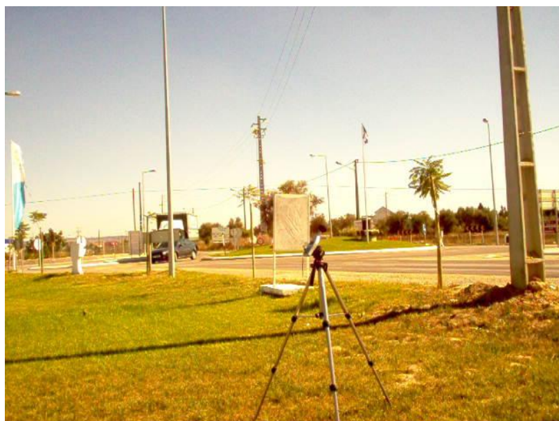
Figura 3.1 – Exemplo de uma medição realizada com o sonómetro numa via rodoviária.
