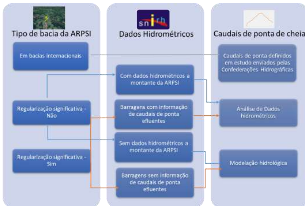
Figura 8. Esquema da modelação hidrológica (Aqualogus e Hidromod, 2020)
