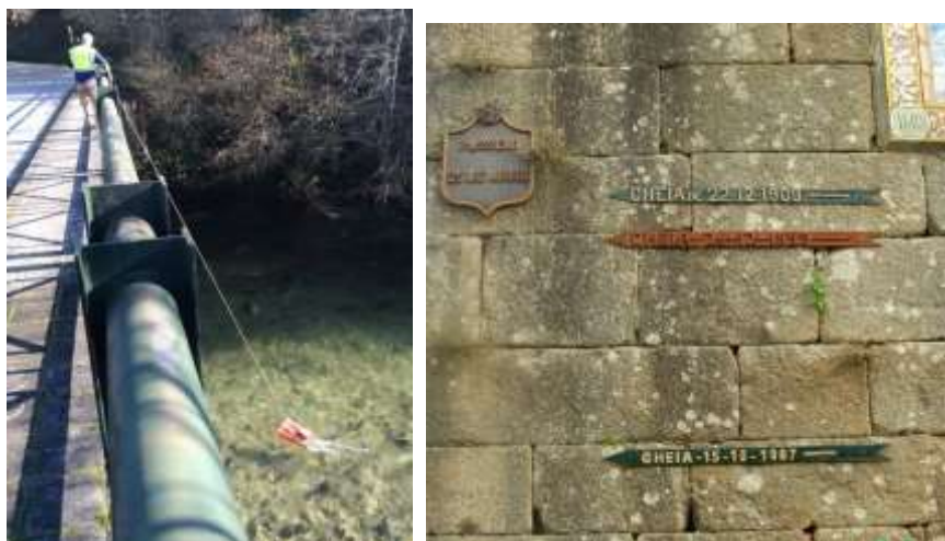
Figura 6. Elementos necessários à modelação hidrológica e hidráulica, medição de caudal e marcas de cheia
