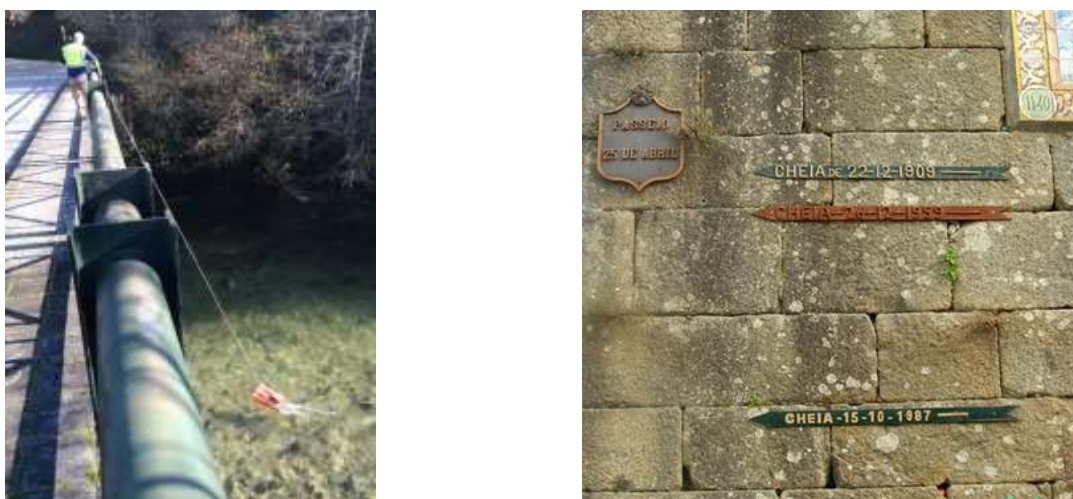
Figura 7. Elementos necessários à modelação hidrológica e hidráulica, medição de caudal e marcas de cheia
