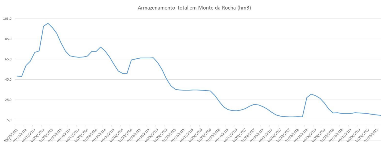
Figura 301 - Volume armazenado na albufeira de Monte da Rocha. (Fonte: AdP).
