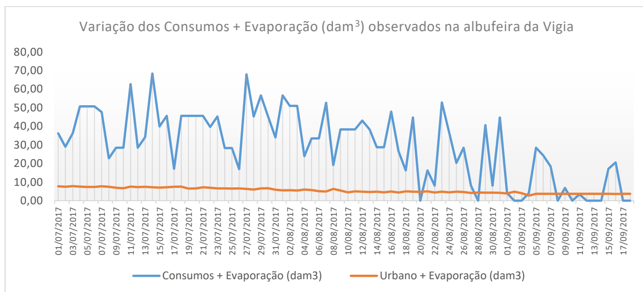
Figura 13 – Evolução dos consumos + evaporação na albufeira da Vigia durante os meses de julho, agosto e a primeira quinzena de setembro de 2017 (1990/91 a 2015/16) (Fonte: APA)
