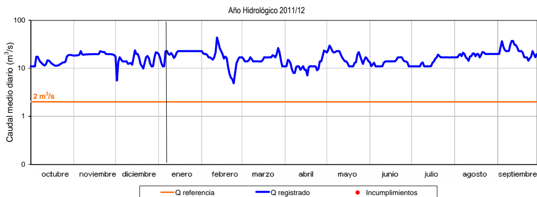
Gráfico22. Aportaciones medias diarias registradas 2011-2012 (Azud de Badajoz) Afluências médias diárias registadas 2011-2012 (Açude de Badajoz)
