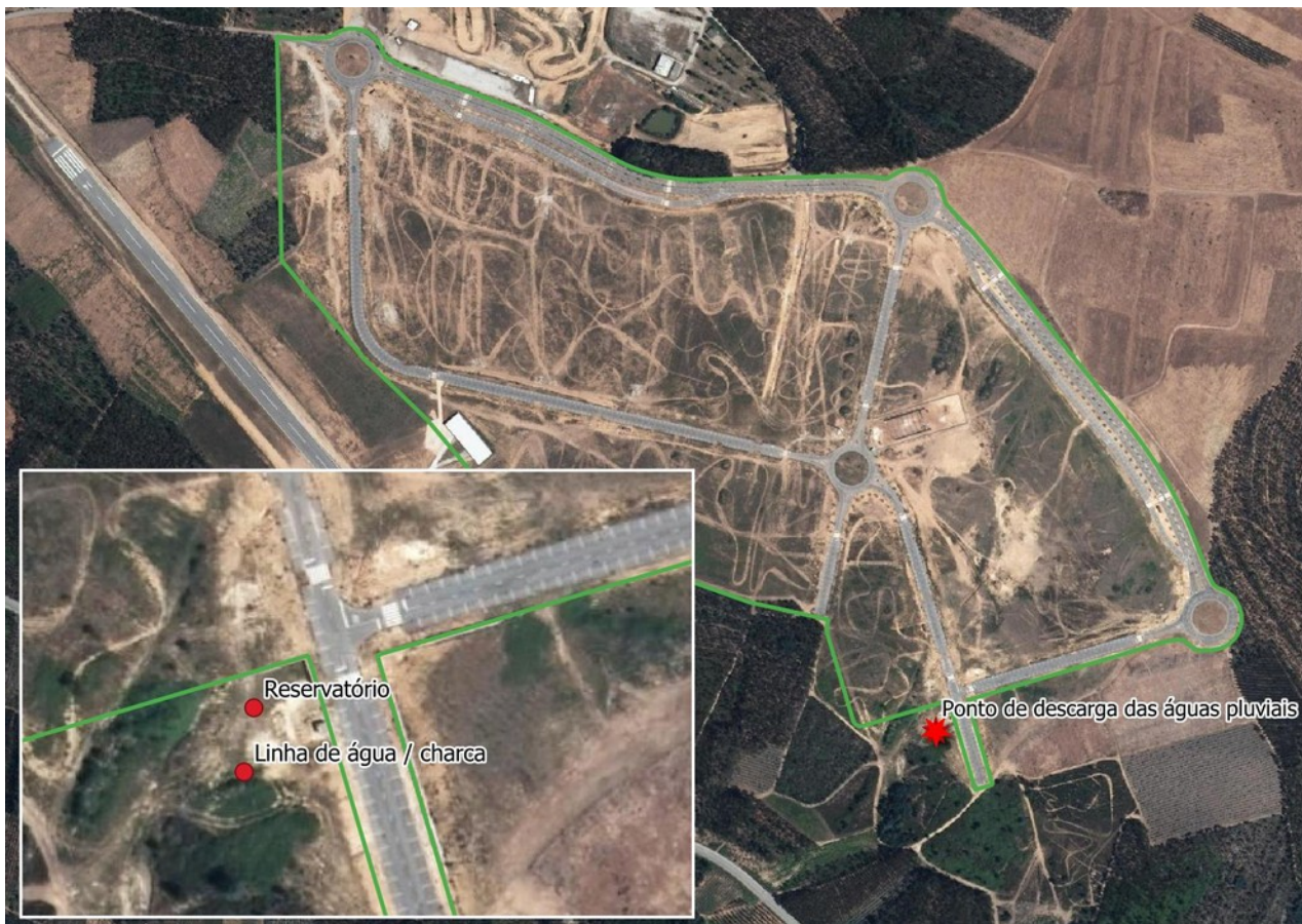
Figura 5 – Localização do ponto de descarga de águas pluviais do PEC (sobre ortofotomapa 2015 DGT).
