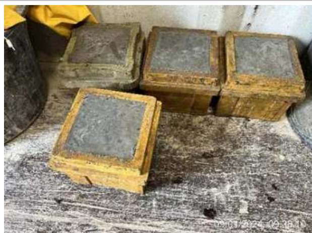
Frente de obra da plataforma Superior do Ascensor – 4 Provetes para ensaio à compressão - 09/01/2023 - GR P518/0084248
